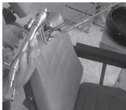
Figura 2. Măsurarea vibrațiilor la piesa-unghi pentru braț dur
